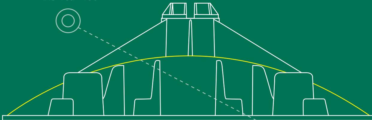
Insert inclinable jusqu'à 7°
