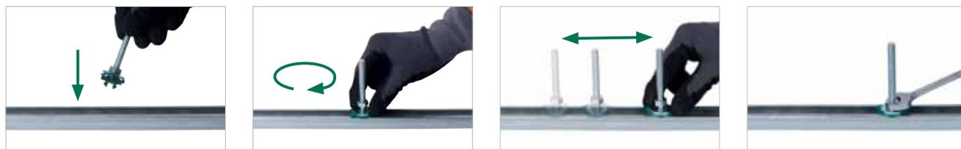
Gli Hammerfix Walraven RapidRail® e i dadi di scorrimento Walraven RapidRail® sono componenti preassemblati "tre in uno" che vanno semplicemente spinti e ruotati all'interno del profilo.
