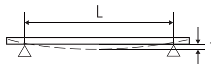
Rysunek 1: Schemat obciążeń, f = maksymalne ugięcie, L = długość
