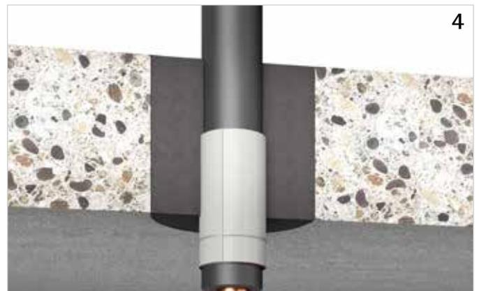
Ringspalt verschließen, z.B. mit Pacifyre® FPM Brandschutzmörtel, Beton, Zementmörtel oder Gips.
