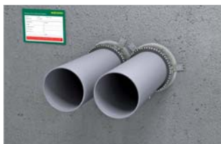
Nulová vzdialenosť medzi manžetami (neizolované potrubie).
