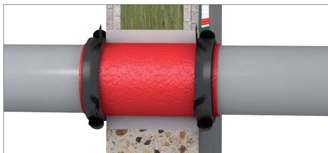
Inštalácia v situácii s pevnou a ľahkou priečkou \geq 100 mm.
