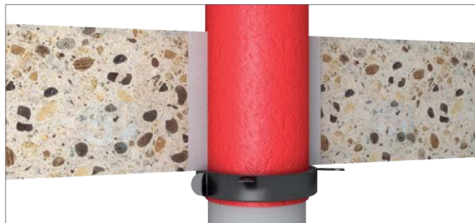
Inštalácia v situácii so stropom \geq 150 mm.
