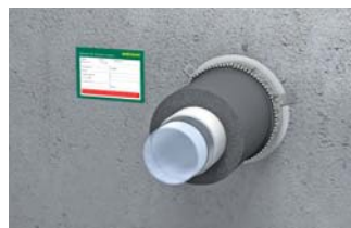
Viacvrstvé potrubie až do vonkajšieho priemeru 110 mm s izoláciou zo syntetického kaučuku.
