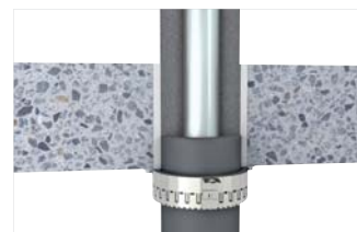
Nehorľavé potrubie s protipožiarnou manžetou na spodnej strane stropu.
