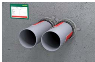
Nulová vzdialenosť medzi manžetami (izolované potrubie).
