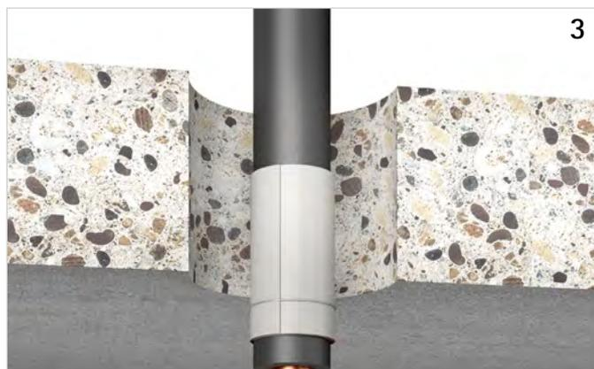
Rohrbandage mit min. 1 Stück Wickeldraht  $d \geq 0,6 \text{ mm}$  unterhalb der Decke fixieren.
