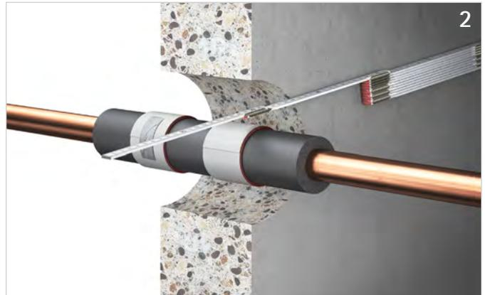
Je Bauteilseite eine Bandagenhälfte so anordnen, dass 15 mm - entspricht einer Zollstockbreite - aus dem Bauteil hervorsteht.
