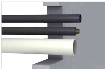
1. Przejście bez zabezpieczenia
