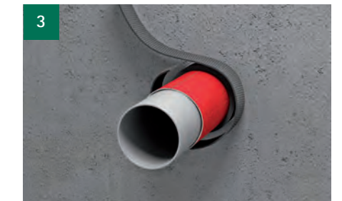
Intumescerend band om buis of isolatie aanbrengen (aantal lagen in acht nemen en met een overlap van 20 mm verlijmen).
