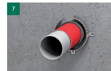
Aan één uiteinde van het RVS-band 2 uitsparingen ombuigen. Beide uiteinden over elkaar leggen en de uitsparingen terug buigen om de manchet te sluiten.
