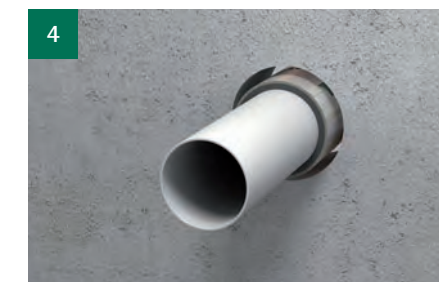
Plaats de manchet in het midden van doorvoering (dient aan beide zijden minimaal 5 mm uit te steken).
