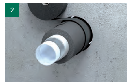
Band om buis (of isolatie) aanbrengen (aantal lagen in acht nemen) en met een overlap van 20 mm verlijmen.
