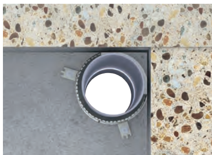
Bijzonder geschikt voor hoekdoorvoeringen (2/3 brandmanchet). Afstand tussen wand en buis \leq 10 mm.
