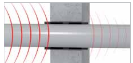
Зменшена передача звуку в сусідні приміщення
