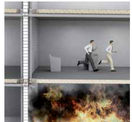
3. Le manchon coupe-feu BIS Pacifyre® MK II entre en action et les personnes ont le temps d'évacuer
