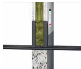
Przejścia w ścianach przewodów elektrycznych w izolacji o średnicy do 50 mm, EI 120.
