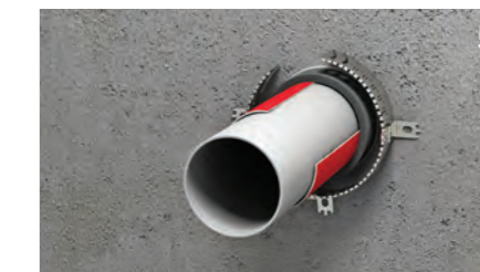
Zum Verschluss des Metallbandes 2 Nasen am Ende des Bandes aufbiegen. Beide Enden übereinanderlegen und Nasen zurückbiegen, um Band zu verschließen.
