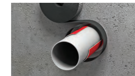
Brandschutzband um Rohrleitungen (bzw. Dämmung) legen (Lagenanzahl beachten!) und Überlappung (ca. 20 mm) verkleben.
