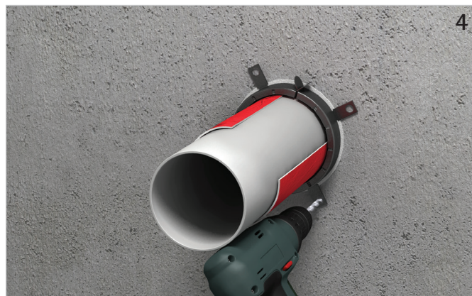
Ggf. anzeichnen und erstellen der Befestigungspunkte (optional dürfen die Laschen auch 90° umgebogen und eingemörtelt werden).
