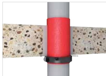
■ Installation sur plafond  $\geq 150$  mm
