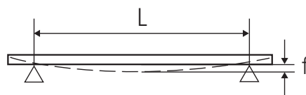
Obrázek 1: Výpočet zatížení, f = maximální průhyb, L = délka
