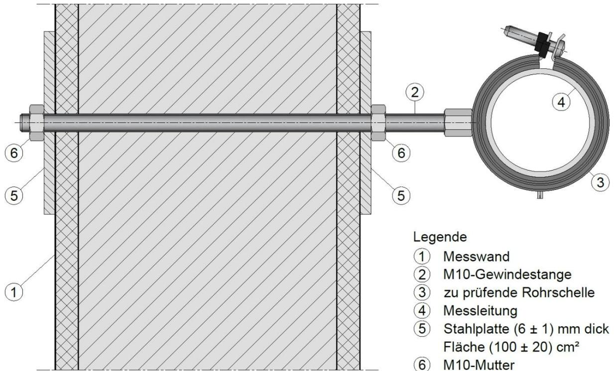
Entsprechend der Ausrüstung der Rohrschelle erfolgte die Befestigung über eine M10-Gewindestange mit passender Mutter.
