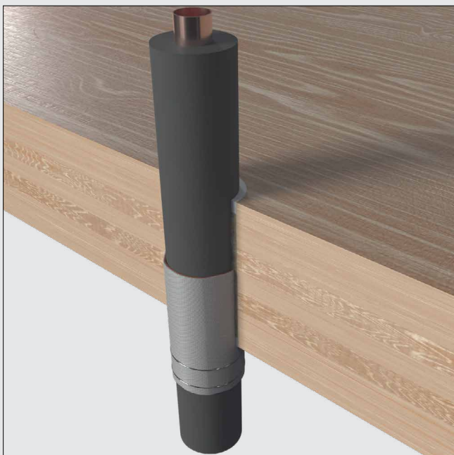
Deckendurchführung gedämmtes Kupferrohr: Abschottungslösung Walraven Pacifyre® NBR-plus Brandschutzband
