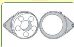
Rollengehäuse öffnen und leere Rolle entnehmen.
