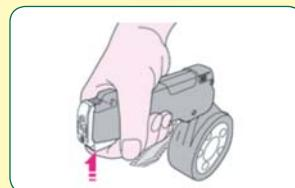
Der STARLOCK® II ist nach einmaligem Drücken der Schneidetaste betriebsbereit. Dadurch wird das erste Schloß in Position gebracht.
