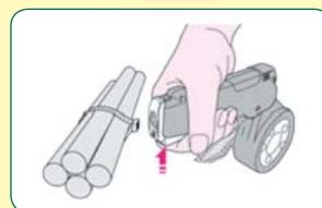
Nachdem das Kabelband positioniert und gespannt ist, Schneidetaste drücken der Arbeitsgang ist abgeschlossen.
