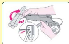
Kabelband in krümmungsrichtung um die zu verbindenden Teile führen (die verzahnte Seite muß nach außen zeigen !) und das Endstück bis zum Einrasten in das Schloßl stecken. Einrasten wird durch ein Klickgeräusch bestätigt.
