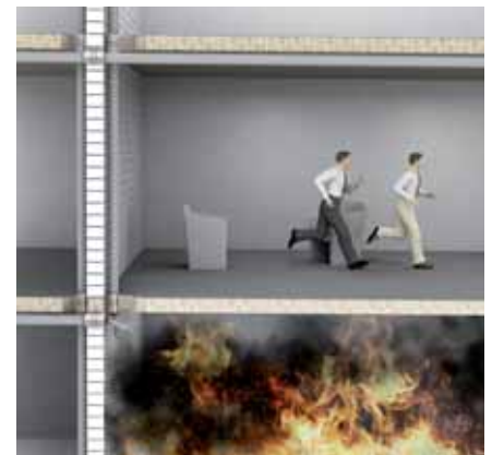
3. Le manchon coupe-feu BIS Pacifyre® MK II entre en action et les personnes ont le temps d'évacuer
