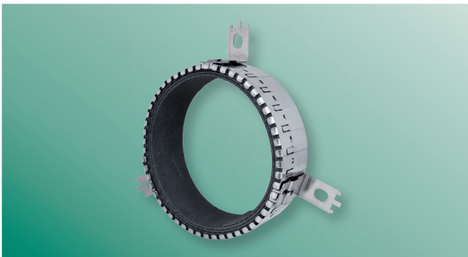
BIS Pacifyre® EFC Brandmanchet Brandwerende opbouwmanchet ter afdichting van (on)geïsoleerde brandbare en meerlagen buizen.
