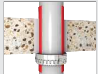
Indbygget situation i loft \geq 150 mm
