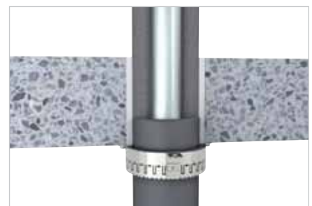
Ikke-brandbare rør med en brandkrave på undersiden af gulvet.
