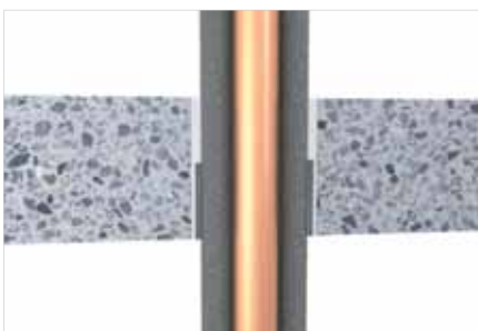
Nehořlavé potrubí s izolací ve stropu.
