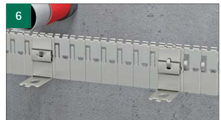
6 Placera Fästet och vik fliken i rostfritt stålband tillbaka över Fästet. Fördela fästena lika över det rostfria bandet.
