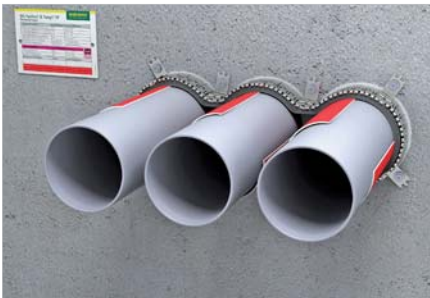
Flera genomföringar (max 3 rör och med 1 Brand krage). Avstånd mellan rör \leq 15 mm.
