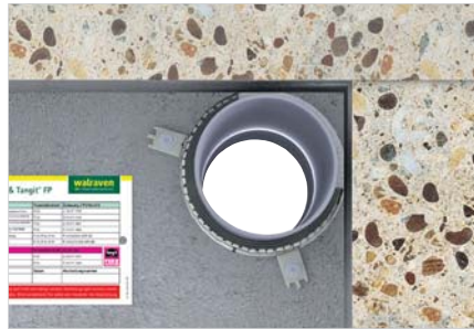
Lämplig för hörn (2/3 brand krage). Avstånd mellan vägg och rör \leq 10 mm.
