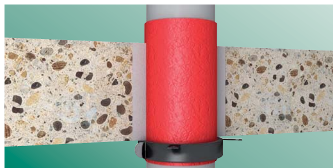
Instalace v situaci se stropem \geq 150 mm
