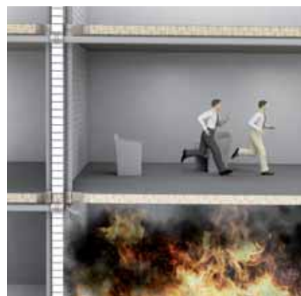
3. Pacifyre® MK II Protipožární manžeta se aktivuje a přítomní mají čas odejít do bezpečí.
