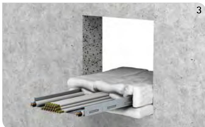
Die Lagen der BIS Pacifyre® IWC Brandschutzkissen so dicht wie möglich um die Kabel verlegen.
