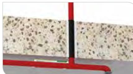
Nicht brennbare (bis Außen-Ø 160 mm) oder brennbare (bis Außen-Ø 32 mm) Sprinklerleitung
