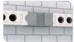
Porenbetondecke (ggf. mit Hohlkammern)
