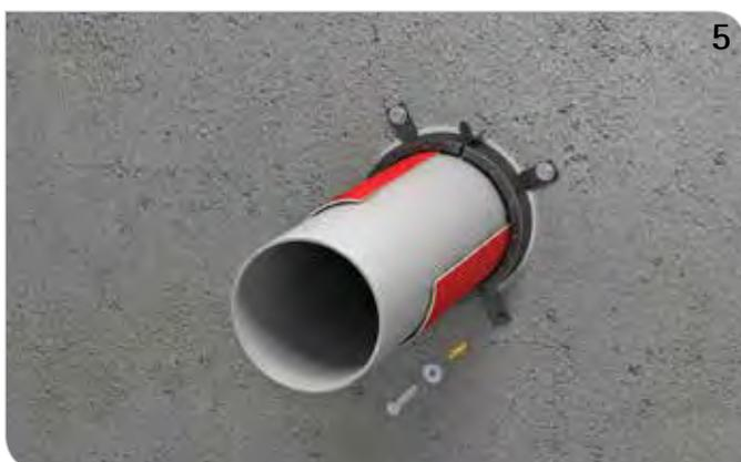
Andübeln der Haltelasche mit dem mitgelieferten Befestigungsset. (Verwendung des Befestigungssets ausschließlich für Stahlbeton).
