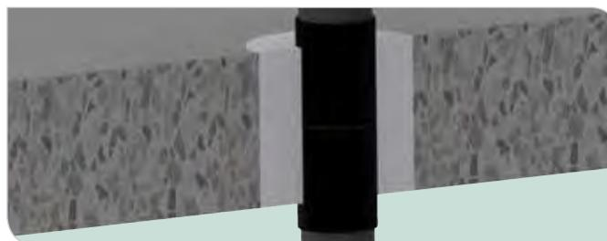
Bei Leichtbauwänden mit einer Bauteilstärke von  $\geq 100$  mm müssen Zusatzmaßnahmen für die Auslaibung (z.B. Einbau von Blechhülsen) getroffen werden. Bei Rohren mit einem Außen- $\varnothing \geq 88,9$  mm wird zudem eine Schutzisolierung benötigt.
