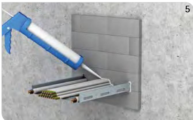
Nach dem Einbringen der BIS Pacifyre® IWS Brandschutzsteine, Restspalte mit Brandschutzkitt verschließen.
